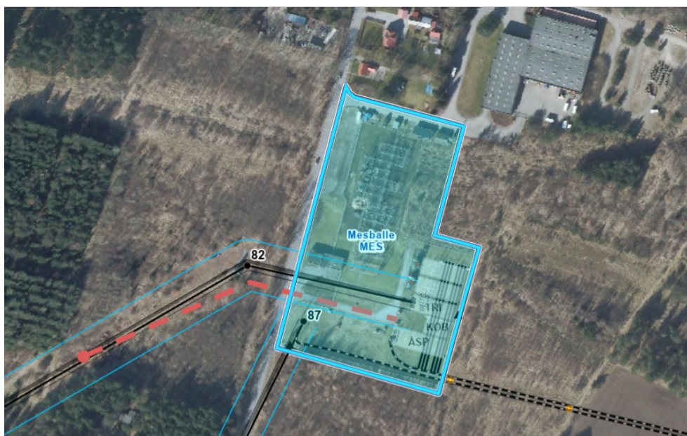
Figur 3 Kabellægning af 250 m luftledning
