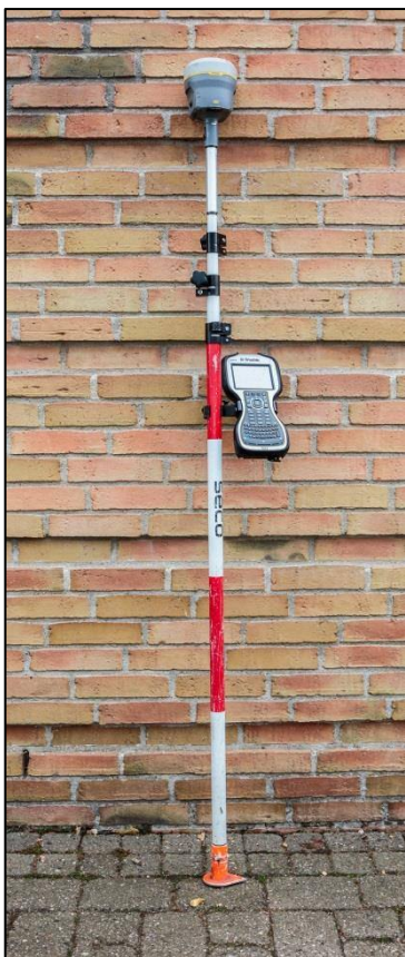
Figur 1 Trimble GPS, monteret på stok med "andefod".
