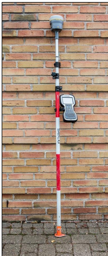
Figur 1 Trimble GPS, monteret på stok med "andefod".
