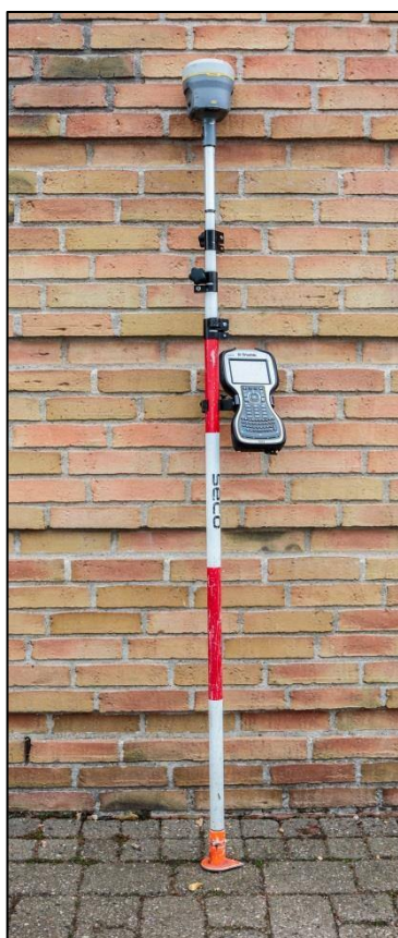
Figur 1. Trimble GPS, monteret på stok med "andefod".
